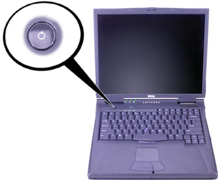
รูปที่ 6-3. การเปิดเครื่องคอมพิวเตอร์
